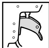
**KONTAKTAUSLÖSUNG, GERÄT MIT ANTIDOPPELSCHUSS-MECHANISMUS**
